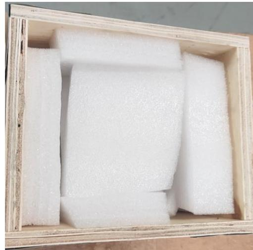
图 1-6 叶片封箱前填充状态
