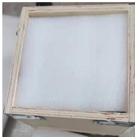
图 6-5 金属电子元件箱内填充状态（封箱前）
