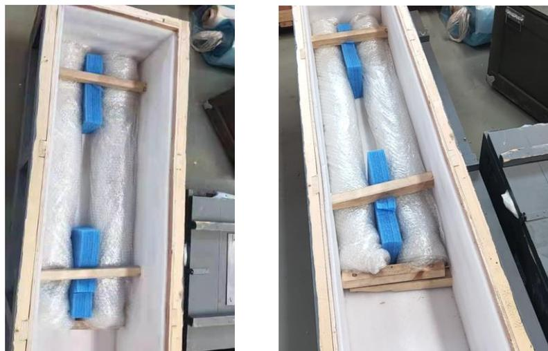
图 3-1 轴类零件箱内固定和包装状态
