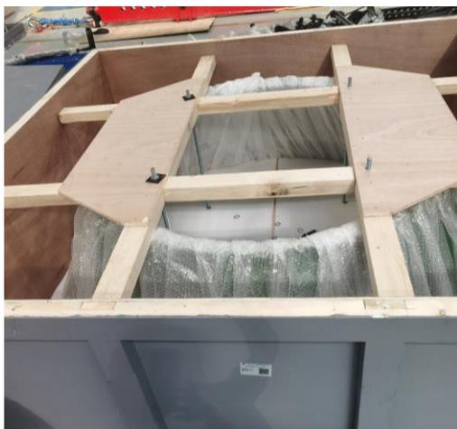
图 5-1 机匣内包装和箱内固定图
