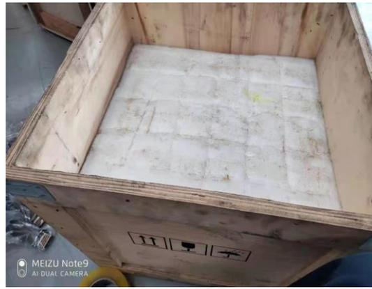
图 1-2 动叶片包装箱内填充状态
