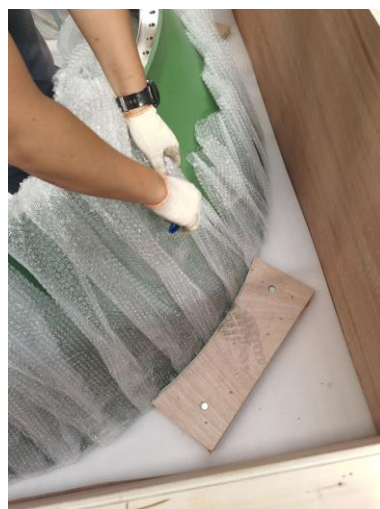
5-2 机匣箱内固定一底部固定
