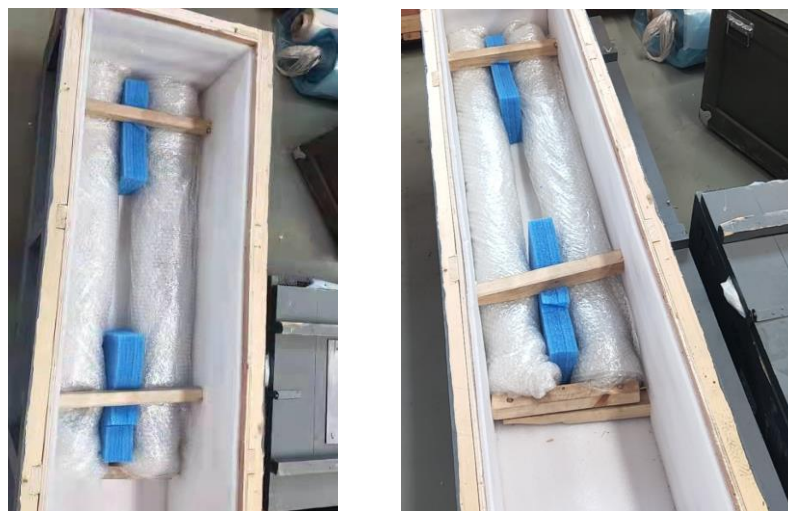
图 3-1 轴类零件箱内固定和包装状态
