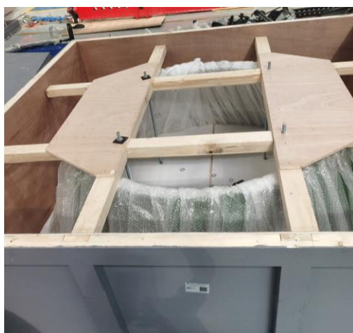
图 5-1 机匣内包装和箱内固定图
