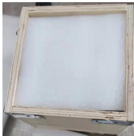
图 6-5 金属电子元件箱内填充状态（封箱前）
