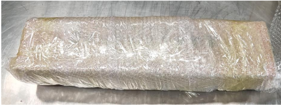
图 6-3 电子产品在自身包装外部缠绕气泡膜
