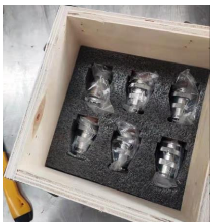
图 6-4 金属电子元件内部包装状态
